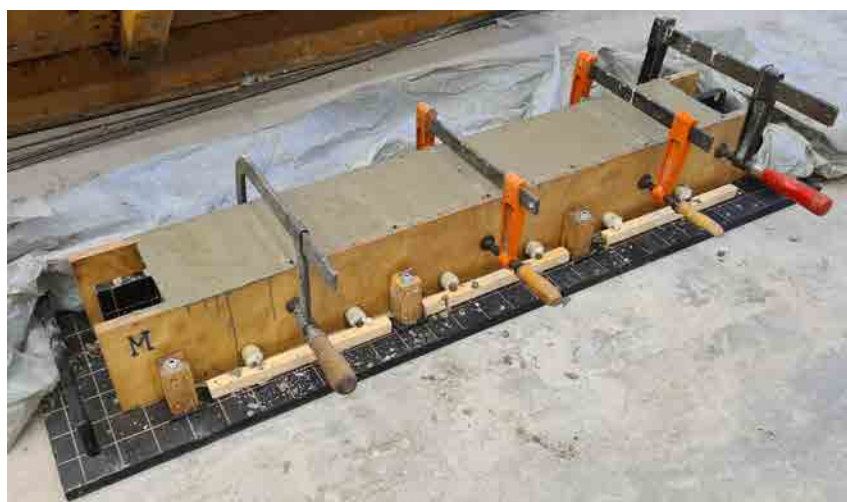
Rysunek 4.13: Przykładowa seria próbek do testu pull-out tuż po zabetonowaniu form.
