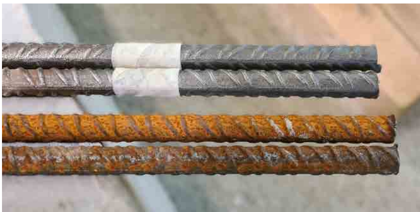
Rysunek 4.10: Porównanie prętów przed i po oczyszczeniu z rdzawego nalotu.
