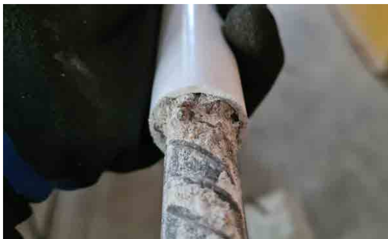
Rysunek 4.24: Niekontrolowane zwiększenia zakotwienia.
