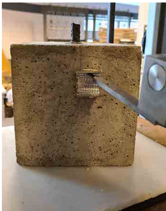
Rysunek 4.17: Sposób pomiaru poślizgu podczas testu pull-out.
