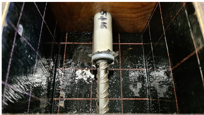
Rysunek 4.12: Wnętrze formy przygotowanej do betonowania.
