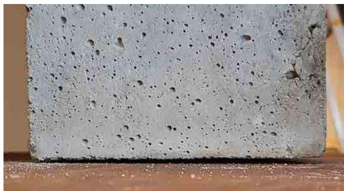
Rysunek 4.26: Nierównomierne przyleganie próbki do płyty klatki.
