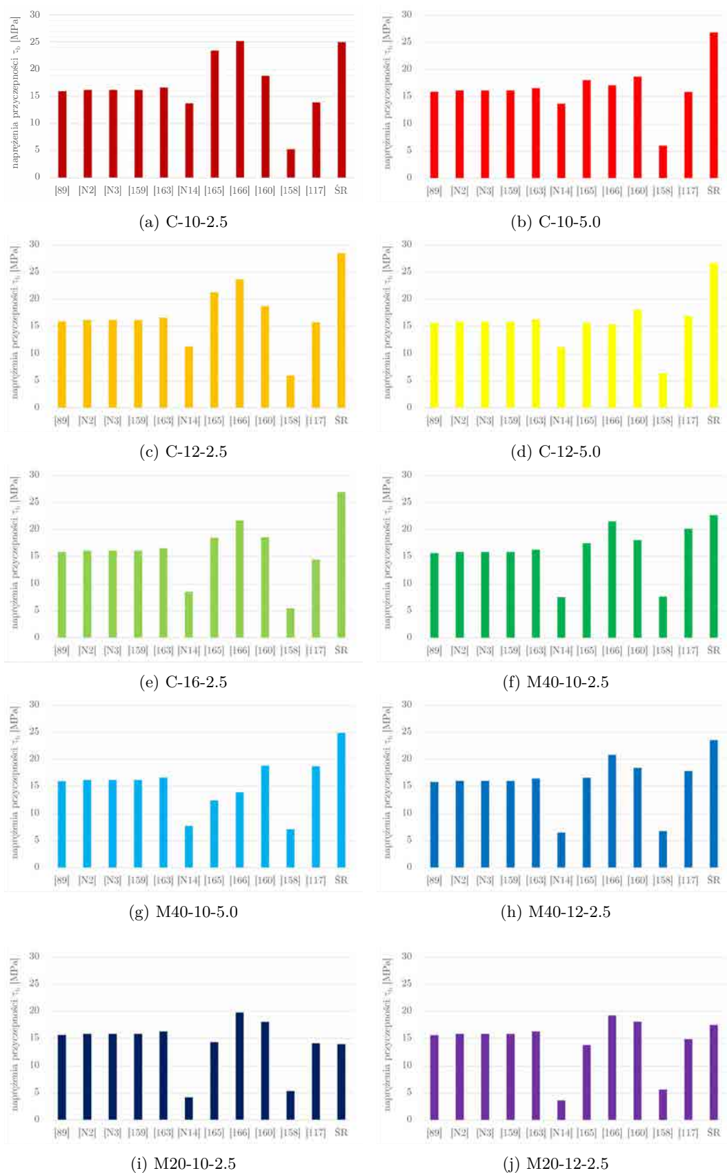
Rysunek 4.39: Analiza porównawcza z modelami przyczepności dla zniszczenia przez wyrwanie.
