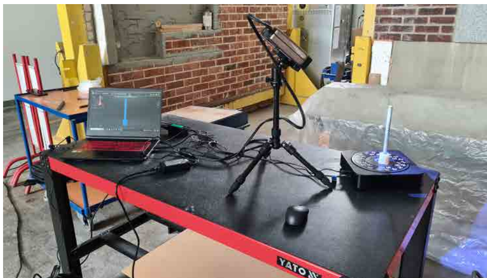
Rysunek 5.18: Stanowisko do wykonywania skanu 3D prętów zbrojeniowych.
